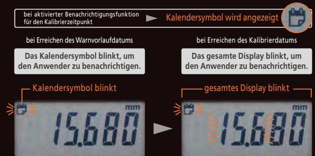
Für die Kalibrierung können das Warnvorlaufdatum sowie das Datum eingestellt werden. Es wird sowohl eine Warnung angezeigt, wenn der Kalibrierzeitpunkt näher rückt, als auch am Kalibrierdatum selbst, um zu verhindern, dass eine Einmessung versäumt wird. Mithilfe dieser Funktion lässt sich das DIGIMATIC-Messgerät effizient verwalten.
